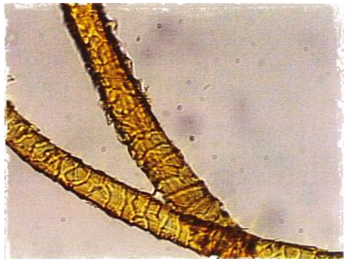
Fig. 4: Secció longitudinal de la fibra de llana
